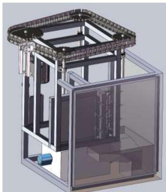
设备采用区块化模块结构，将清洗、切割、包装三大模块单元独立建模并有序排列。大葱由上方旋转链条夹持输送，按节拍依次完成清洗、定长切割与自动包装，实现连续、稳定的流水化处理。
