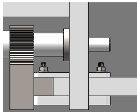
综合使用螺钉与螺栓螺母等进行连接与紧固
